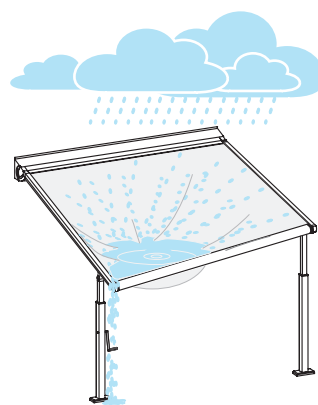
Bei Überschreiten der Regenklasse 2 (56l/h/m 2 ) muss die Plaza Viva zwingend eingefahren werden. Beschädigungsgefahr!
